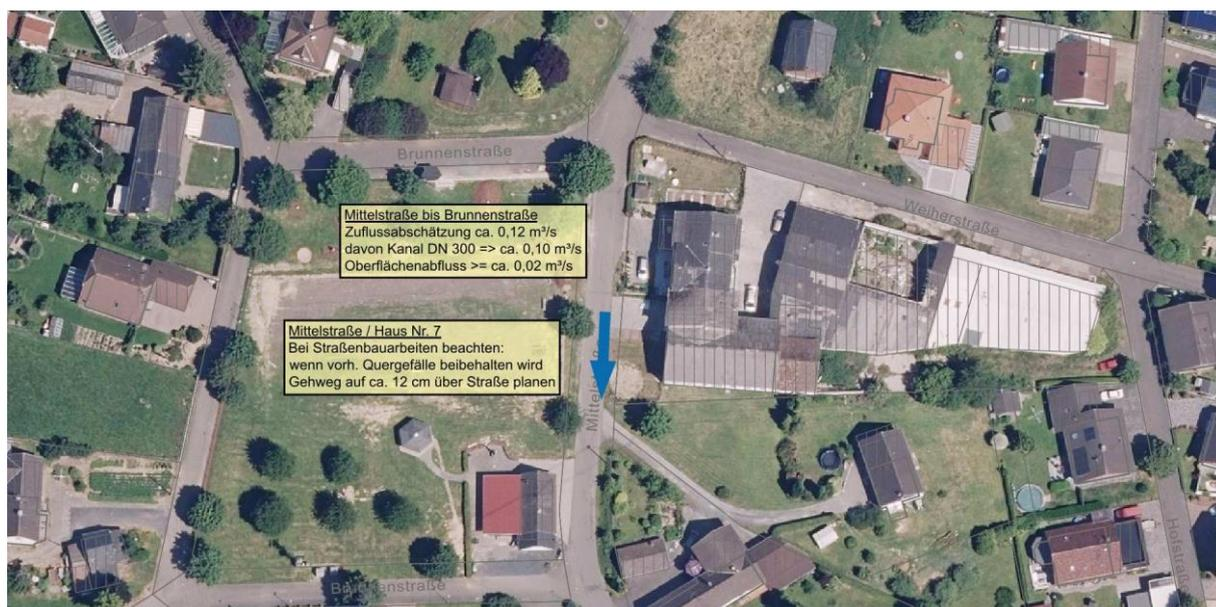
Im oberen Abschnitt ist vor dem Anwesen Nr. 7 eine Anhebung des Gehwegs zur Abflusslenkung zu empfehlen.
