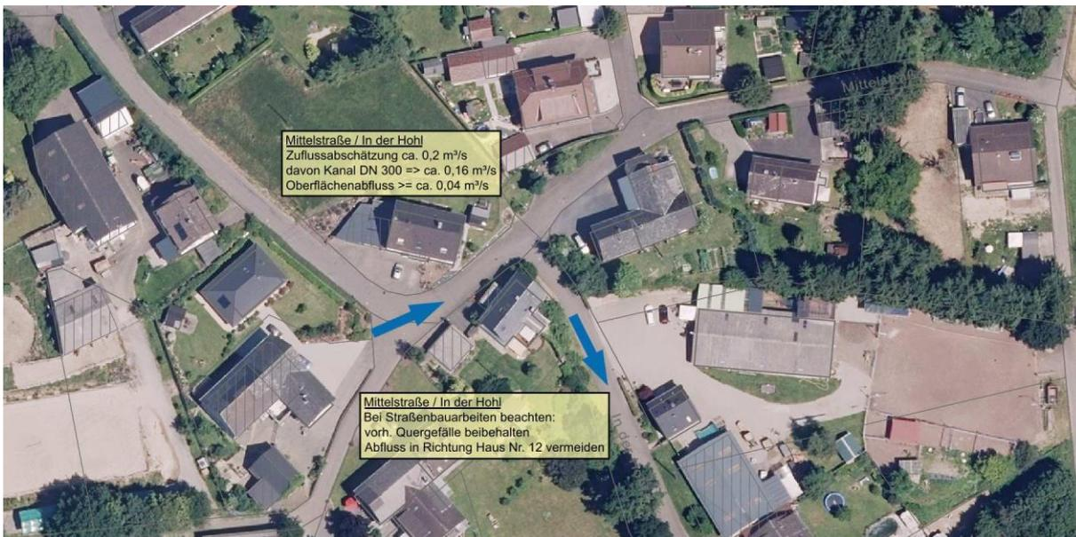
Im unteren Abschnitt ist das vorgefundene Quergefälle beizubehalten. Dies gilt insbesondere für den Bereich vor dem Anwesen Nr. 12, da dort erhöhte Anforderungen für die Wasserführung im Kurvenbereich gelten.
